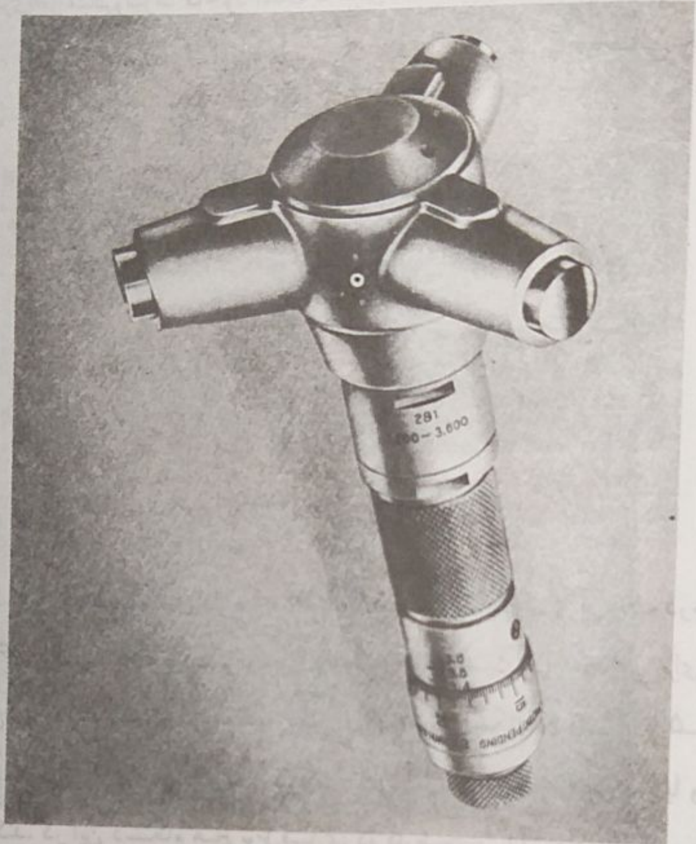
شکل ۵-۱۵: میکرومتر داخل سنج برای اندازه‌گیری قطر داخلی
